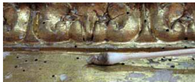
Fig. 41 — Pormenor de um friso durante a limpeza química.
