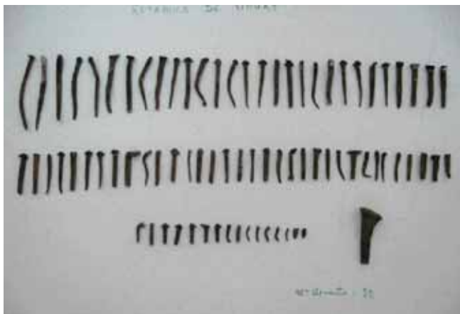
Fig. 36 — Conjunto dos cravos metálicos removidos do retábulo e painel de madeira durante a desmontagem.
