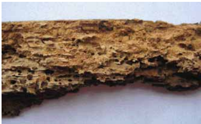
Fig. 9 — Pormenor do reverso da predela, evidenciando o ataque de térmitas.
