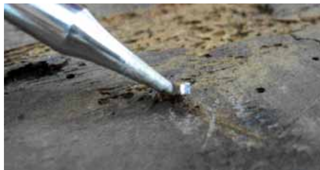
Fig. 62 — Pormenor durante a dilatação de um dos cravos com ferro de soldar.
