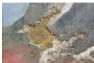
IMAGEM 8 - PULVERULÊNCIA DA CAMADA DE PREPARAÇÃO E CONSEQUENTE PERDA DE MATERIAL.
