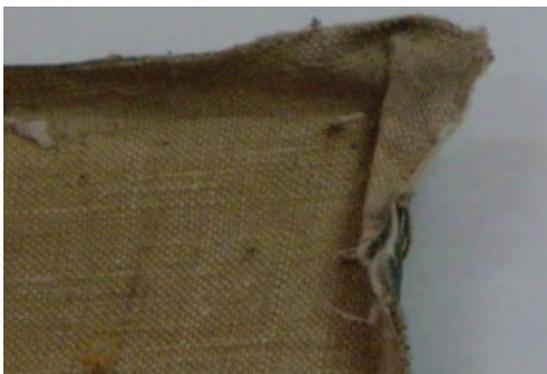
IMAGEM 11 - DEFORMAÇÃO DO SUPORTE TÊXTIL.
