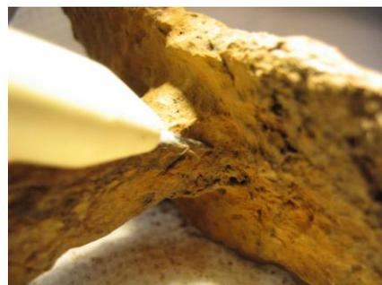
**Figura 12** – Pormenor da limpeza mecânica:
