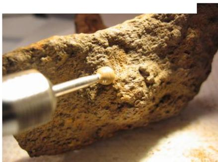
**Figura 13** – Pormenor da limpeza mecânica com mini-craft com ponta de diamante: remoção de terras e óxidos de ferro.
