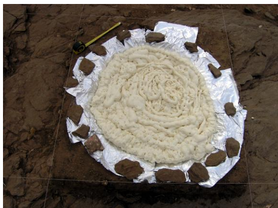
Fig. 4 – A caixa de areia uma vez o interior consolidado com paraloide e efectuado o respectivo molde interno em poliuretano expandido.
